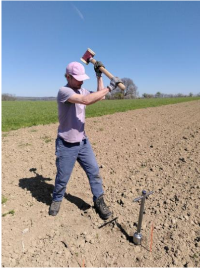
Abbildung 69. Die manuelle Probenahme zur umfassenden Charakterisierung der Versuchsflächen war zeit- und arbeitsintensiv. Für die initiale Modellbildung mussten neben der Enzymaktivität auch Textur, Bodendichte, Kohlenstoffgehalt und pH-Wert exakt ermittelt werden (links). Rechts: Die Versuchsflächen mit Weizen- und Maiskulturen auf der Swiss Future Farm in Tänikon.
