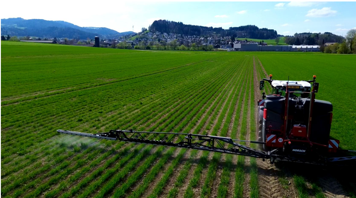
Abbildung 31. Fendt 620 mit Horsch Leeb CS 1.4 beim Spot Spraying. Nur die Düsen links aussen sind aktiv.
