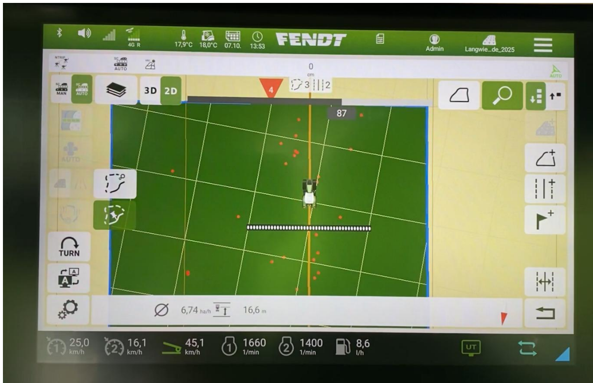
Abbildung 32. Darstellung einer Spot-Spraying Applikationskarte im FendtONE Terminal
