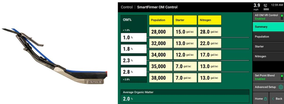
**Abbildung 28:** SmartFirmer-Bodensensor von Precision Planting für den Anbau an der Sämaschine (links) und die Einstellung der Saatstärke basierend auf der gemessenen organischen Substanz am 20/20 Gen 3 Sämaschinen-Terminal (rechts).
