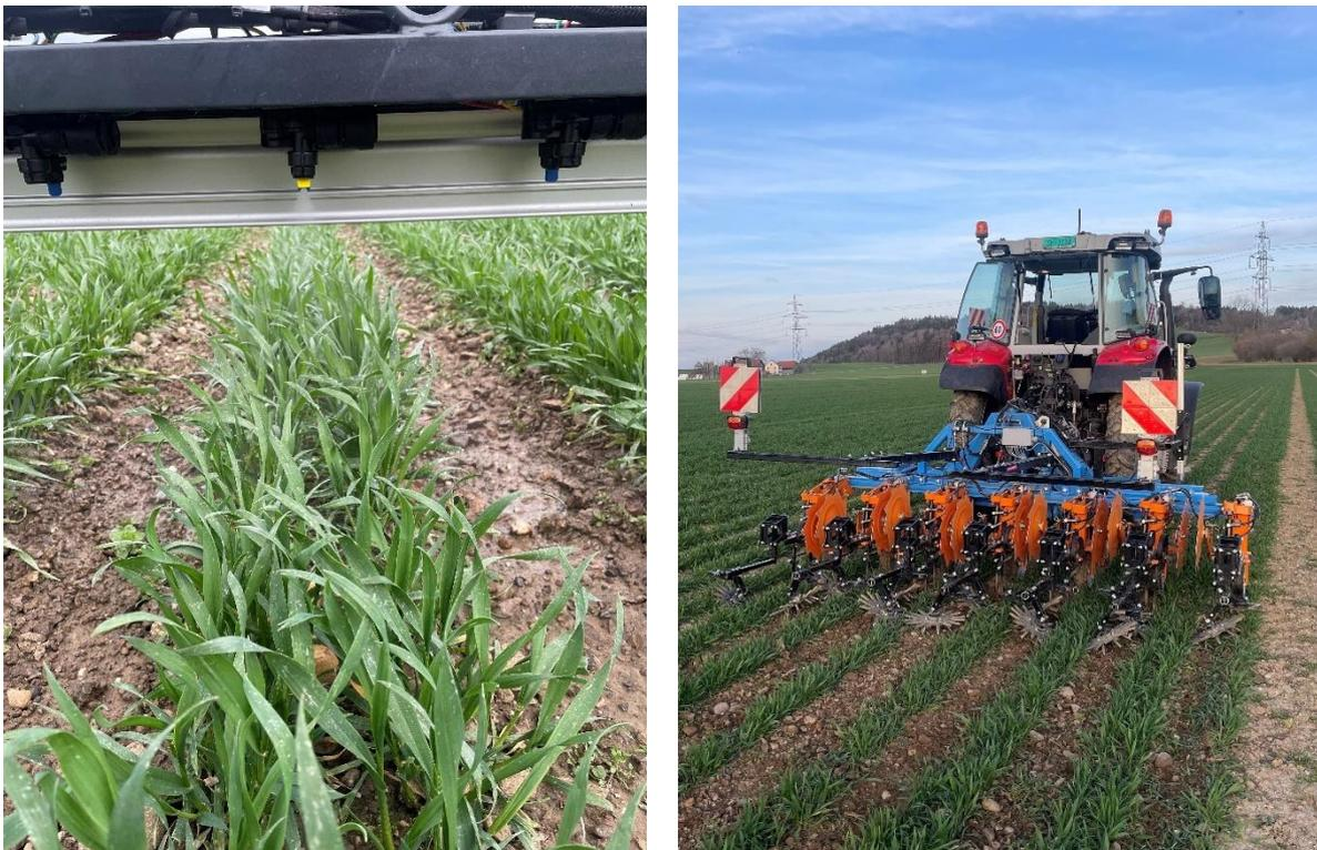
**Abbildung 17:** Bandspritz-Funktion der Anbauspritze Horsch Leeb CS 1.4 (links) und Hackgerät Schmotzer (rechts), die für den Versuch zu Weite Reihen und Bandspritzung bei Winterweizen verwendet wurden.
