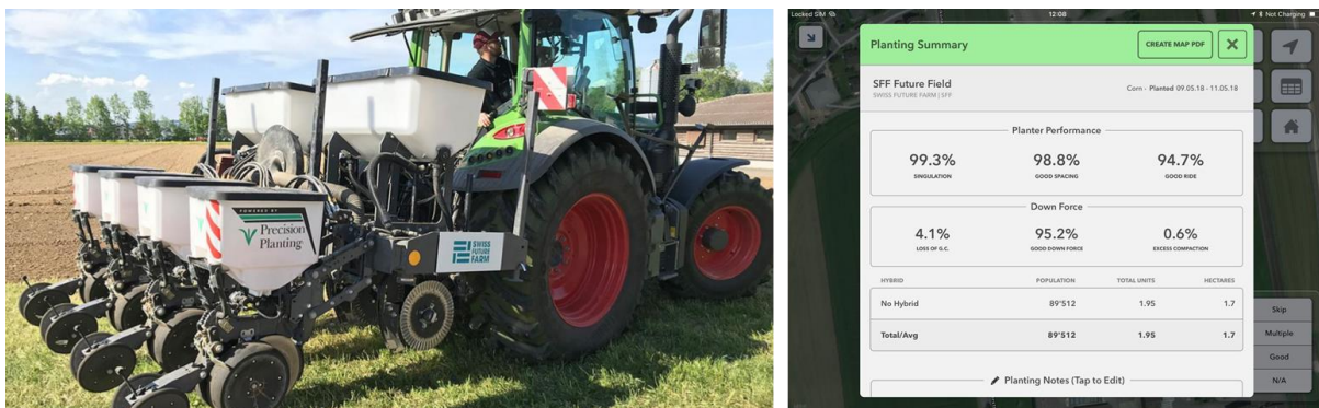
Abbildung 24: Dokumentation der Sämaschinenleistung mit 20/20-Terminal und Climate FieldView-App.
