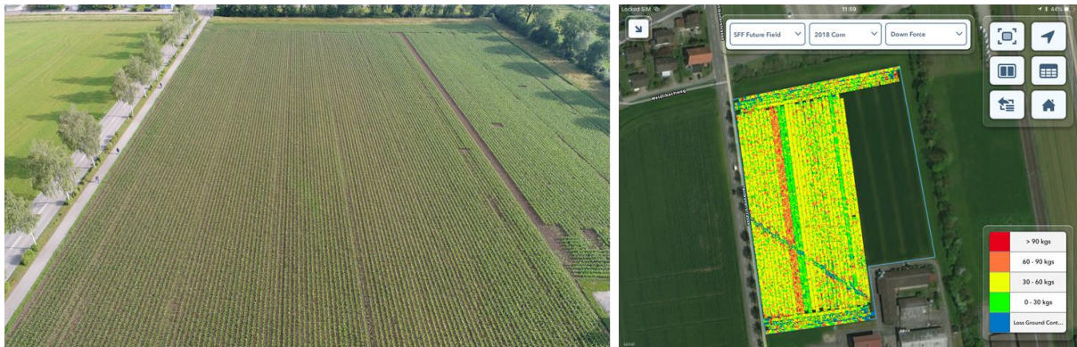
Abbildung 25: Schardruck-Messung mit Precision Planting DeltaForce und Visualisierung im Climate FieldView-App mit deutlich erkennbarem Verdichtungsstreifen (blau) auf der Versuchsfläche.
