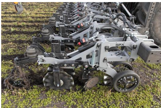
Abbildung 7. Horizon SPX Strip-Till-Gerät während der Feldarbeit (links), Flügelschar mit Tiefeneinstellung zur Streifenanlage für die spätere Aussaat (rechts).
