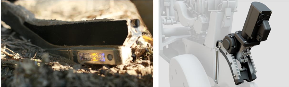
Abbildung 5: SmartFirmer von Precision Planting zur Messung der Bodenfeuchte in der Saatfurche (links) und SmartDepth von Precision Planting zur Echtzeitanpassung der Ablagetiefe entsprechend der Bodenfeuchte (rechts).
