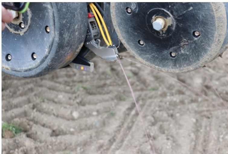
Abbildung 35: Für die Aussaat auf den Versuchstreifen wurde das Flüssigdüngersystem FurrowJet eingesetzt.
