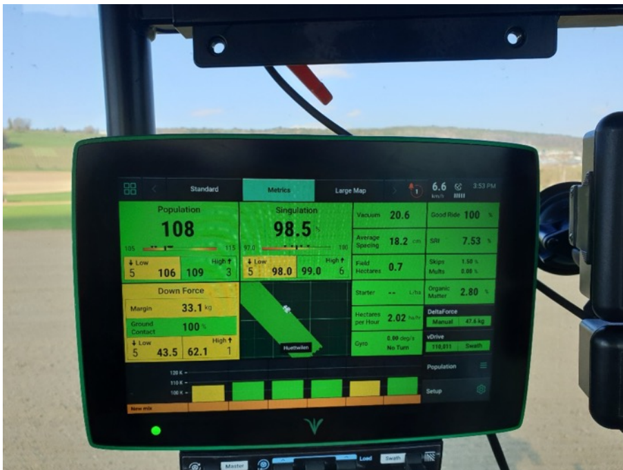
Abbildung 15: 20/20-Monitor der dritten Generation von Precision Planting zur Regelung der Schardruckeinstellung mit DeltaForce während der Aussaat.
