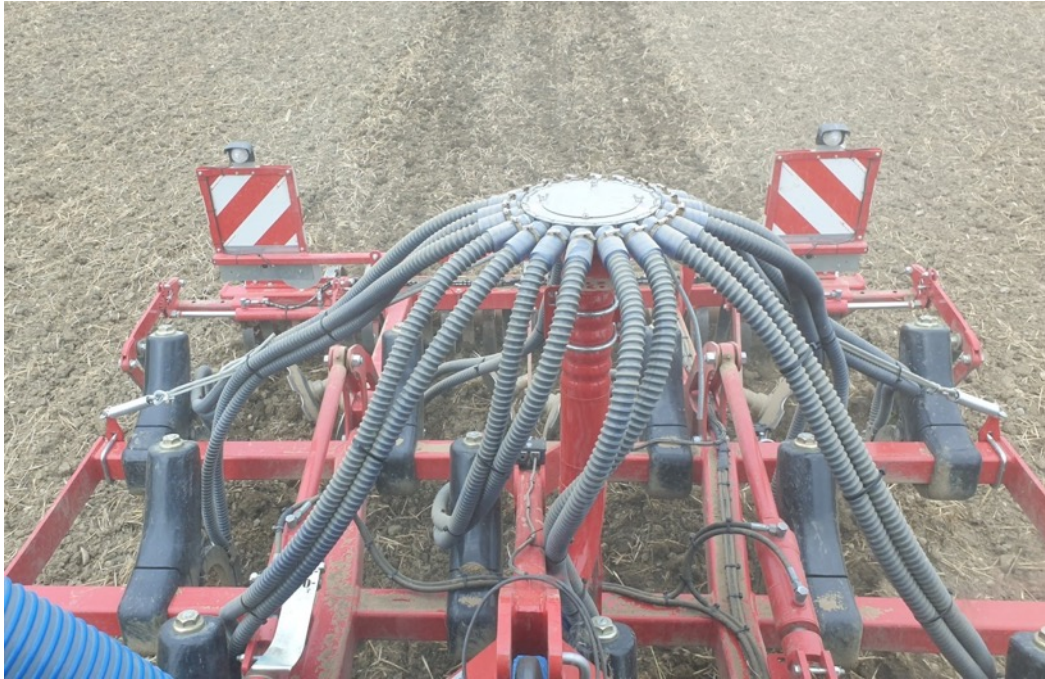
Abbildung 61: Verteilturm des Grubbers.
