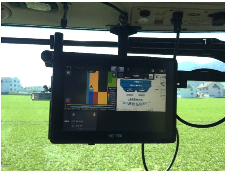
Abbildung 45: Universal Terminal CCI 1200 mit Düngapplikationskarte und ISOBUS-Bedienmaske für den Düngerstreuer.
