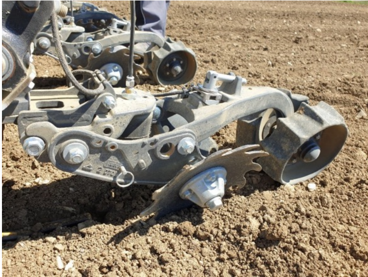
Abbildung 17: Mit dem pneumatischen Furchenschliesssystem FurrowForce von Precision Planting kann mehr Feuchtigkeit im Boden gespeichert und auch bei herausfordernden klimatischen Bedingungen der Ertrag gesichert werden.
