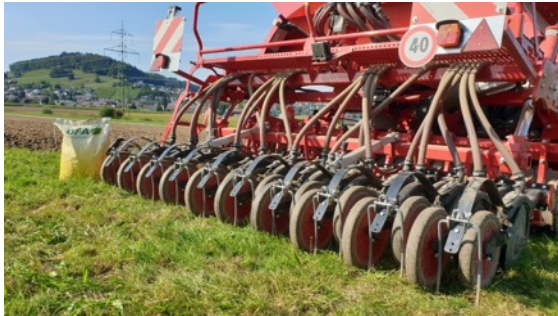
Abbildung 58: Horsch Express 3KR Drillsätkombination mit modifizierter Zuordnung der Säschröuche vom Verteilturm zu den Säschröaren.
