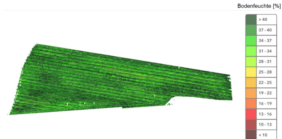
Abbildung 24: Ergebnisse der Feuchtemessung in den Furchen mit SmartFirmer-Bodensensor während der Aussaat auf dem Versuchsfeld in der Studie zu variablen Saatstärken in Silomais 2020 der SFF.
