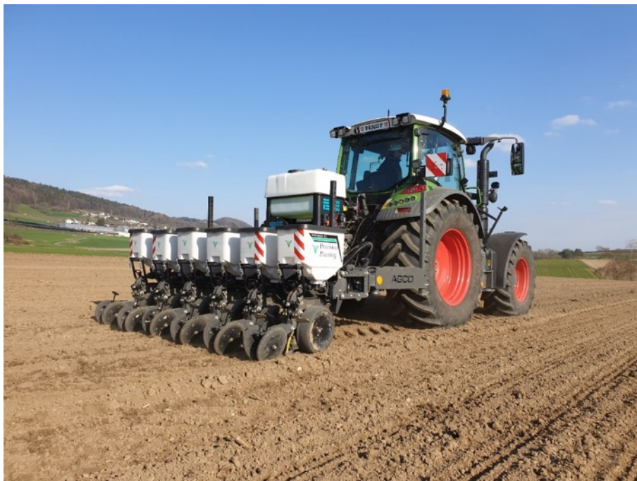
Abbildung 10: Für die Aussaat auf den Versuchsstreifen wurde eine Sämaschine von Precision Planting mit dem Flüssigdüngersystem FurrowJet eingesetzt.
