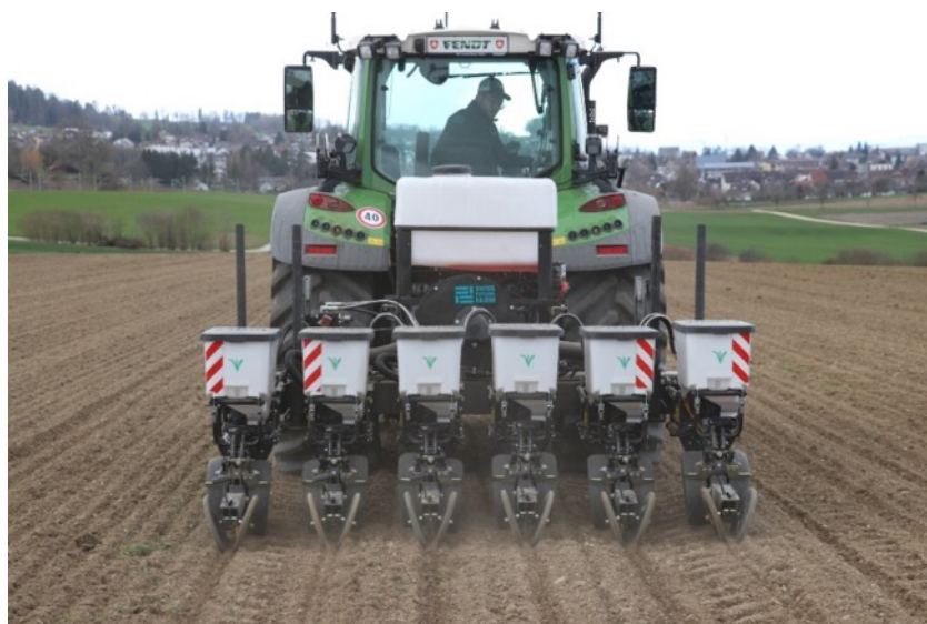
Abbildung 40: Für die Aussaat auf den Versuchstreifen wurde eine Sämaschine von Precision Planting mit der automatischen Schardruckregelung DeltaForce eingesetzt.
