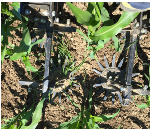
Abbildung 50: Fingerhacken im Einsatz gegen Grasbüschel in der Reihe.
