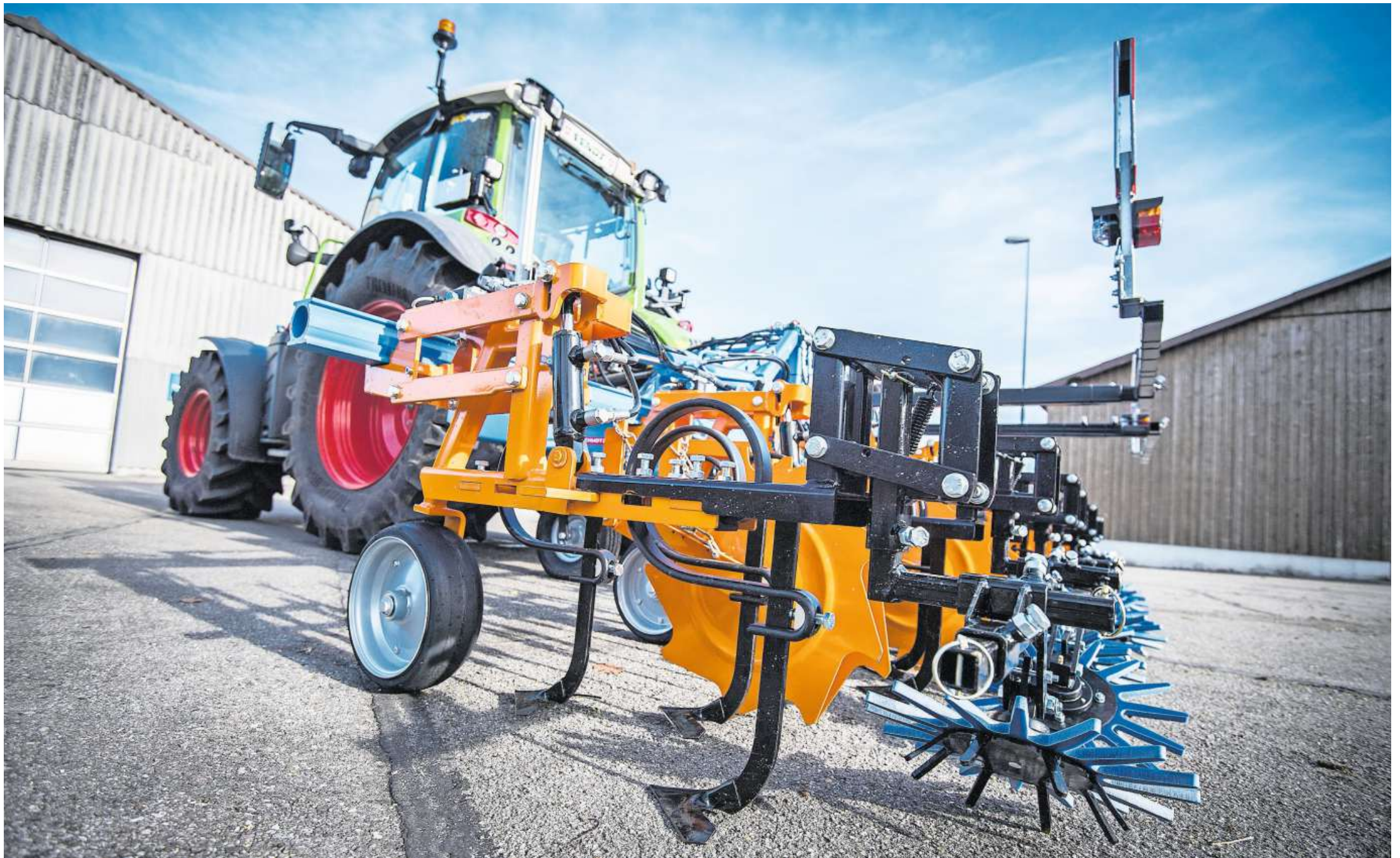
In der Swiss Future Farm wird getestet, wie effizient sich dieses Hackgerät computergesteuert einsetzen lässt.
